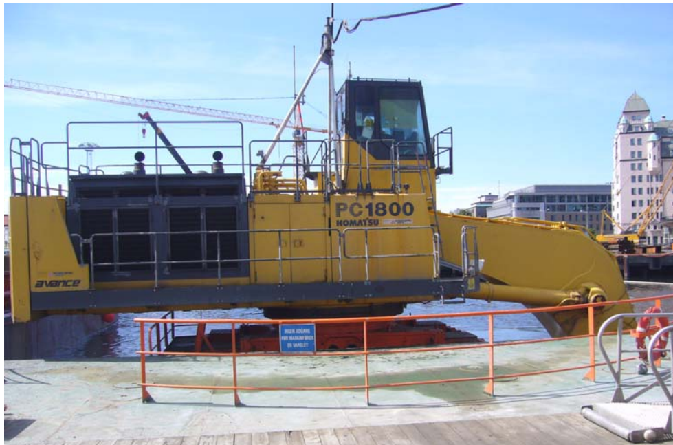
Figur 1: Foto av gravemaskinen på mudringsfartøyet som benyttes til mudring av de forurensede sjøsedimentene i Oslo havn
