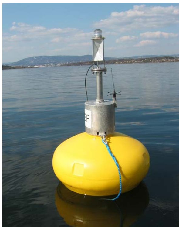
Figur 4: Foto av målebøye utplassert ved dypvannsdeponiet.
