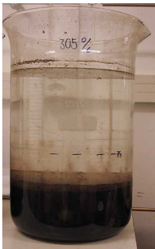
Figur 6 Tildekkingsforsøk med sand over sedimenter med 305 % vanninnhold.
