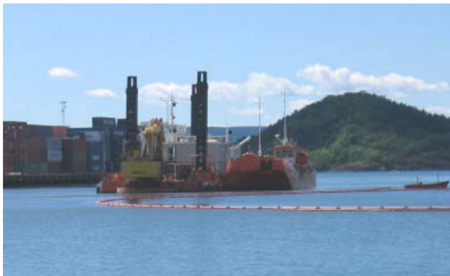
Figur 1 Foto av mudringsfartøy og transportlekter som benyttes til mudring av de forurensede sjøsedimentene i Oslo havn.
