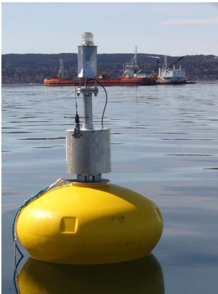
Figur 4 Foto viser en av overvåkningsbøyene ved dypvannsdeponiet.
