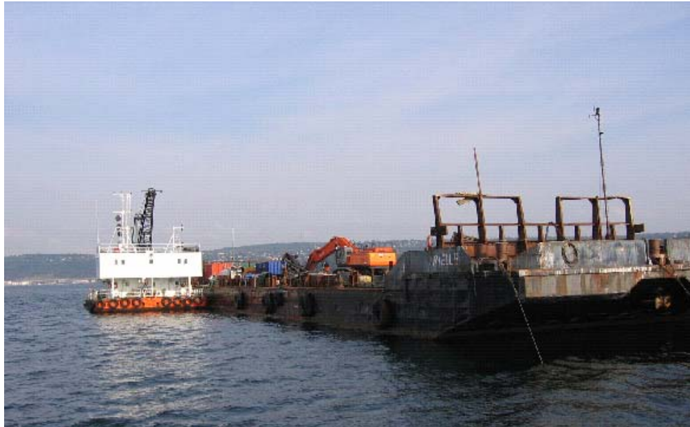
Figur 3 Lekter ved dypvannsdeponiet ligger klar for nedføring av mudrede masser.
