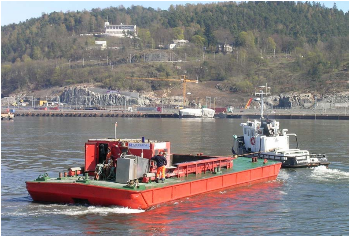
Bilde 5: Til tildekking med ren leire i områder på 15 – 20 meters dybde benyttes fallbunnslekter. Foto: Elin Sæther, HAV.
