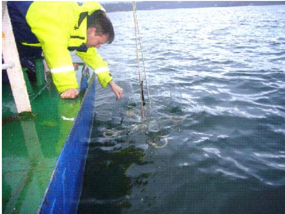
Figur 6 Sedimentfelleriggen, som består av fire oppsamlingsrør som holdes vertikalt i vannmassene i en egen oppsatts heises opp til overflaten ved HAVs fartøy Pelikan.
