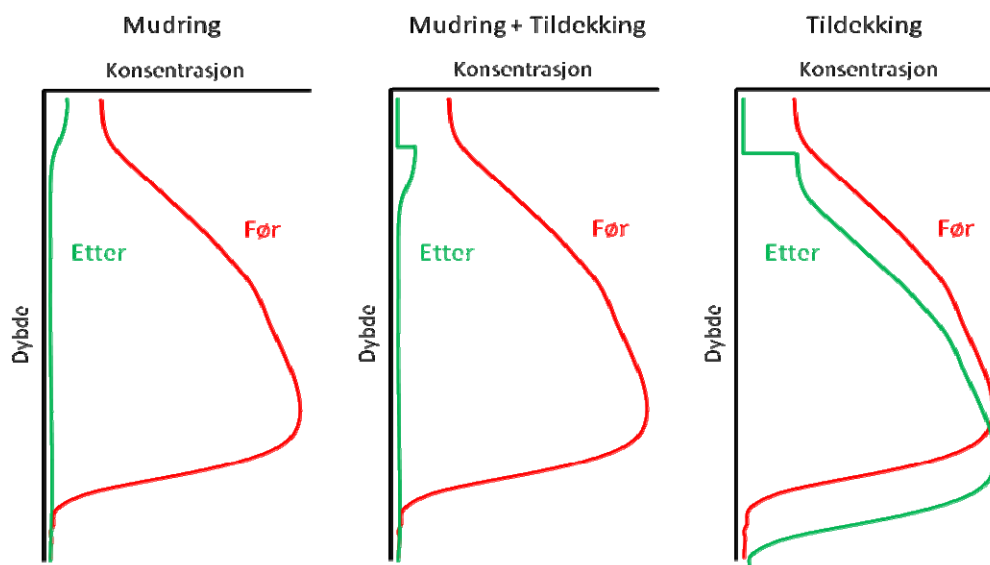
Figur 8 Ny sjøbunn etter gjennomførte tiltak, der nivåene av forurensning før og etter tiltak er illustrert.
