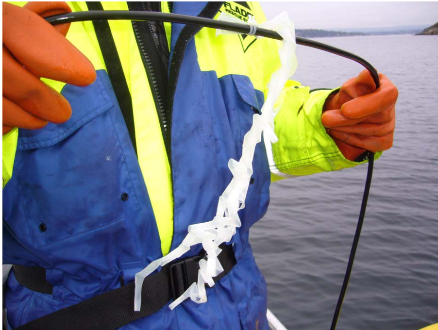
Figur 7 Foto som viser utsetting av passive prøvetakere for tidsintegrert analyse av vannkonsentrasjon av fritt løst PAH og PCB.
