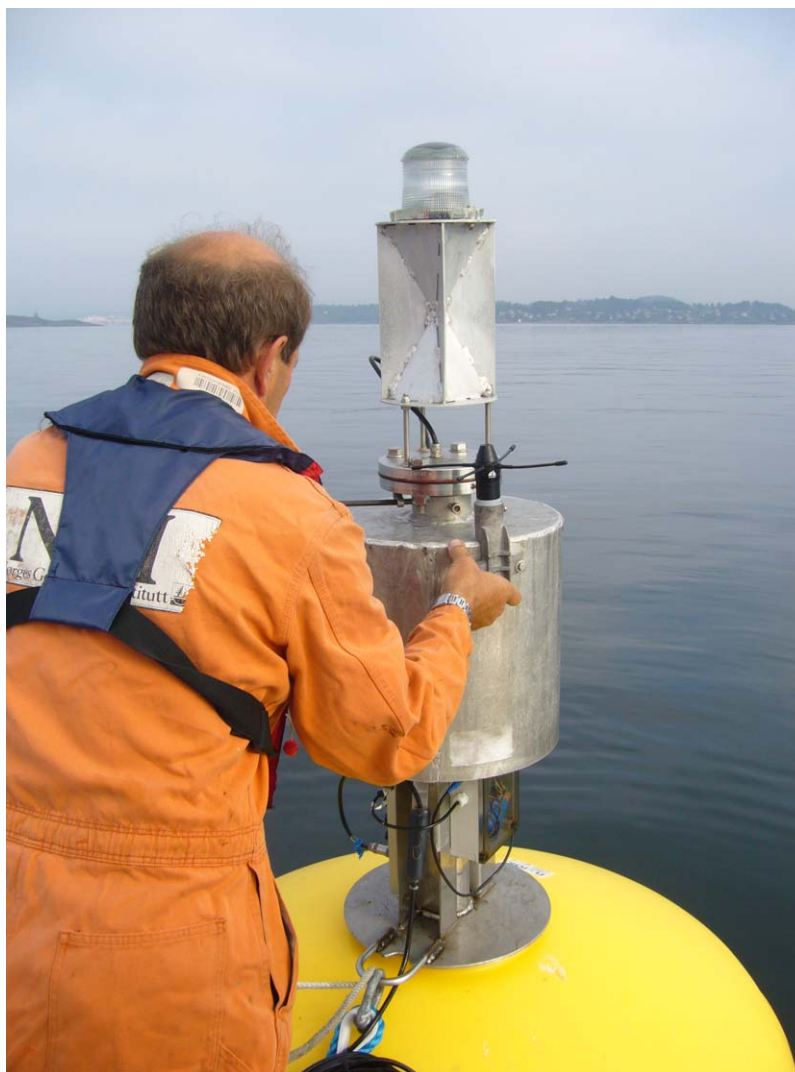
Figur 4 Foto fra vedlikehold av en av overvåkningsbøyene ved dypvannsdeponiet.
