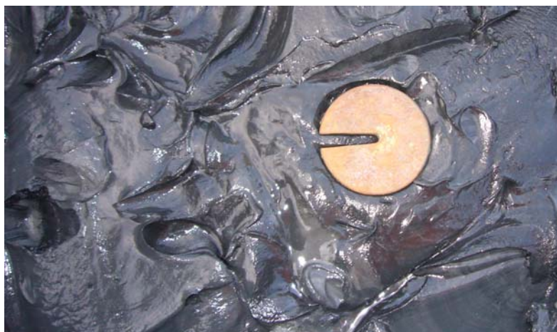
Figur 5 Bilde av platebelastningsforsøk utført på en boxcoreprøve
