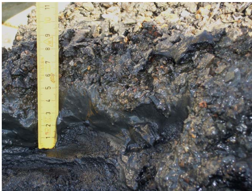
Figur 9 Boxcore prøve tatt ved B-1 som viser et tydelig sandlag over de deponerte sedimentene
