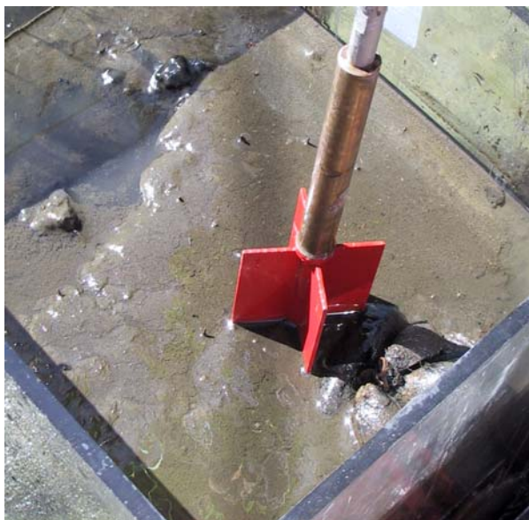
Figur 4 Bilde av vingebor brukt til vurdering av skjærfasthet
