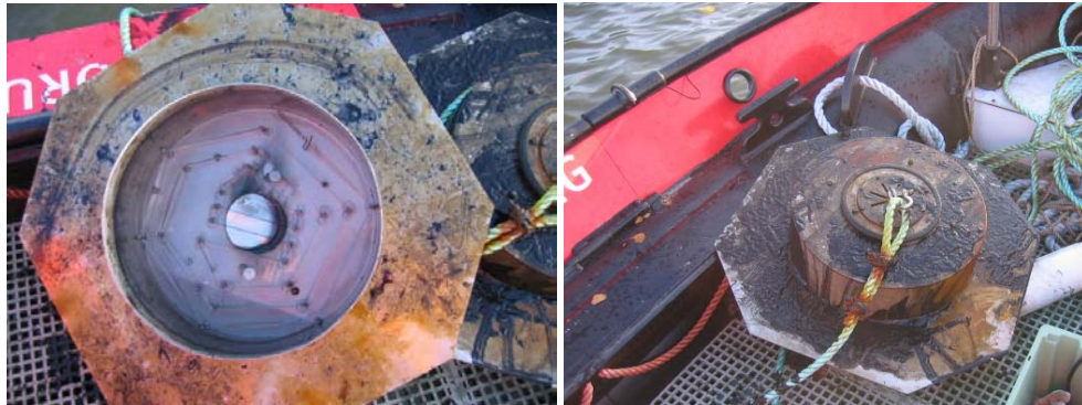
Figur 3 Diffusjonskammeret fra innsiden (t.v.) og sett ovenifra (t.h.)
