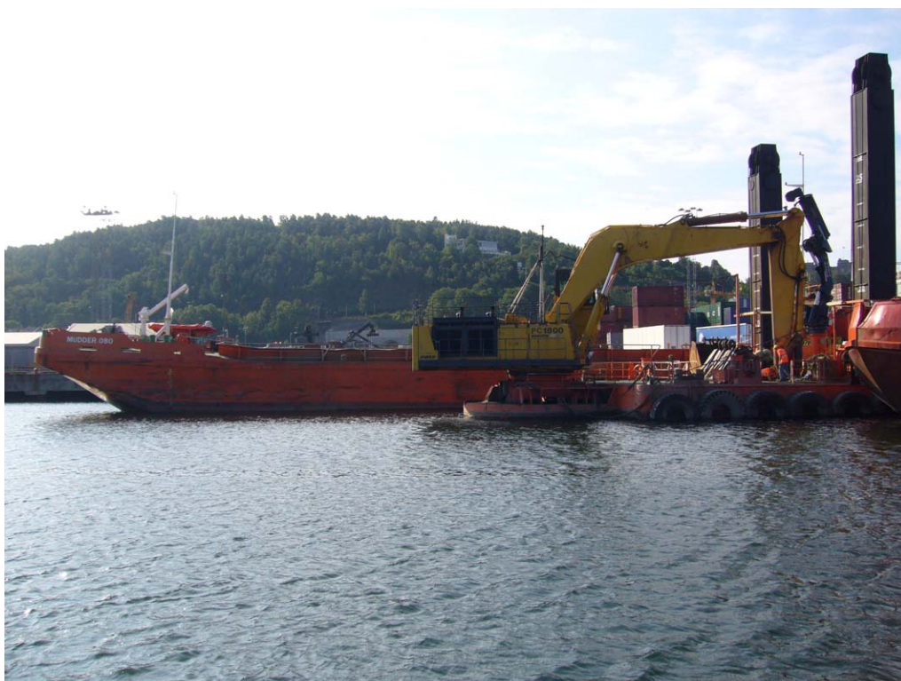
Figur 1 Foto av mudringsfartøyet som benyttes til mudring av de forurensede sjøsedimentene i Oslo havn. I bakgrunnen ligger Mudder 080, en av lekterne som frakter mudrede masser til dypvannsdeponiet
