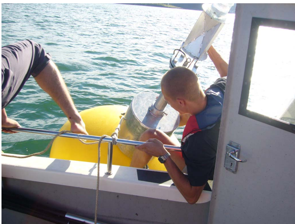
Figur 4 Foto utplassering av målebøye ved dypvannsdeponiet. I juni ble målebøyen på stasjon MP4 skiftet ut slik at alle bøyene rundt deponiet nå inngår i samme varslingsystem og vedlikeholdsrutiner
