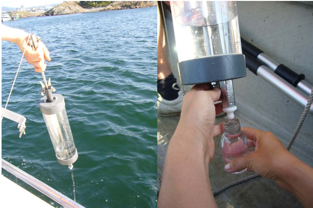
Figur 7 Fotografiene viser prøvetakning med vannhenter og overføring av prøve til egen emballasje for kvikksølvanalyse
