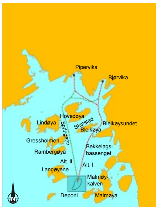
Figur 3.3: Trasè for dykket rørledning fra havnebassenget til deponistedet
