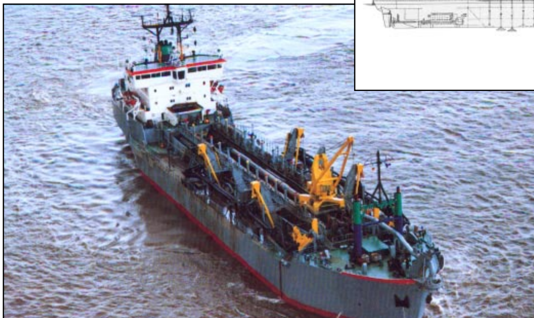
Figur 3.5: "Trailing suction hopper dredger" (selvgående lastefartøy) til bruk både i mudringen og i transporten av forurensede sedimenter til deponistedet.
