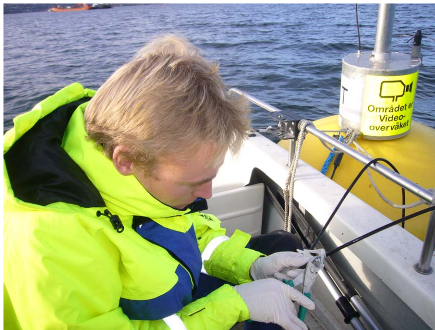
Figur 10 Innhenting av passive prøvetakere utplassert rundt dypvannsdeponiet ved Malmøykalven
