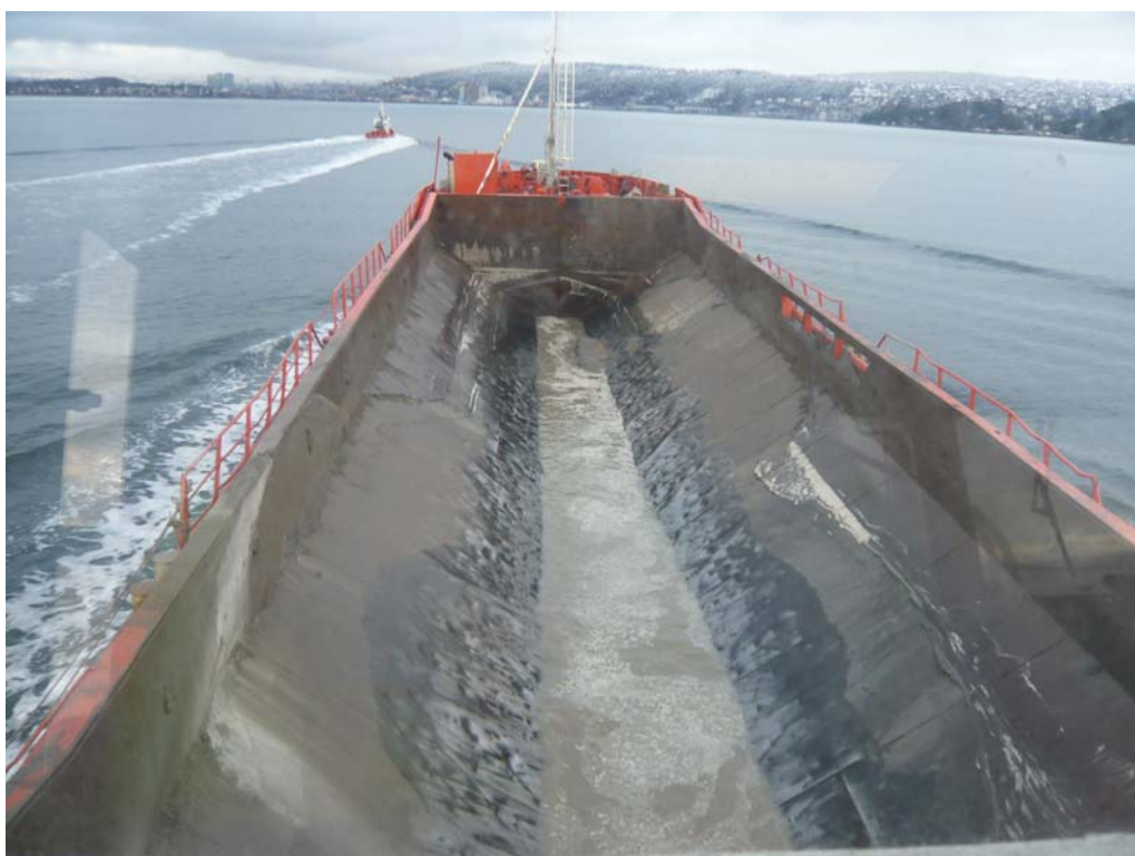
Figur 6 Lekteren lukkes og vender tilbake til Sørengutstikkeren for lasting av mer tildekkingsmasse.
