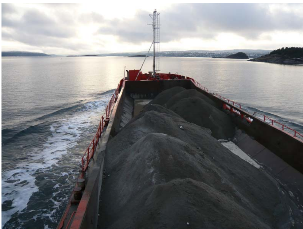
Figur 2 Splittlekter M079 på veg ut mot dypvannsdeponiet med ca 700 m 3 tildekkingsmasse.
