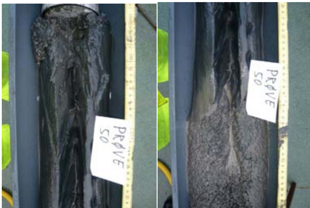
Figur 4 Fotografi av kjerneprøve fra stasjon 50 som viser 3 cm sand på toppen av de deponerte massene (venstre), og i sjikt 40-77 cm nede i underliggende masser (høyre).
