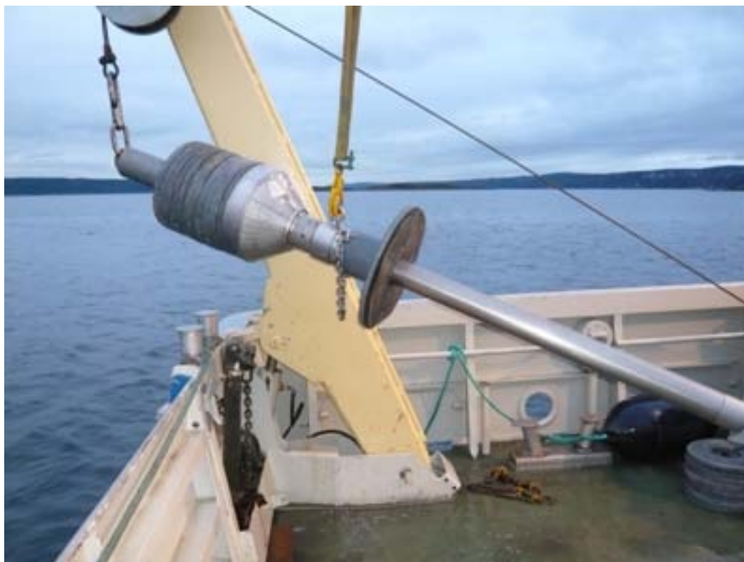
Figur 1 Gundersen coreren består av en variabel loddetsats(450-1100 kg) med en spesiell "truge" for å hindre overpenetrasjon under prøvetakning. For å penetrere sandlaget er prøverøret (110 mm) utført i tynnvegget stål og påmontert skjær med spesielt utviklet sandfang for tett avlukking av prøvematerialet.
