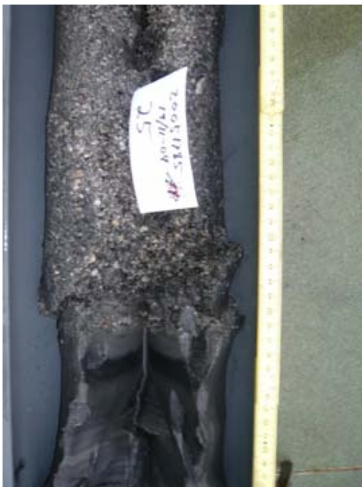
Figur 3 Fotografi av kjerneprøve fra stasjon 25 som viser sandlaget på toppen av dypvannsdeponiet, klart avskilt fra de underliggende deponerte massene.
