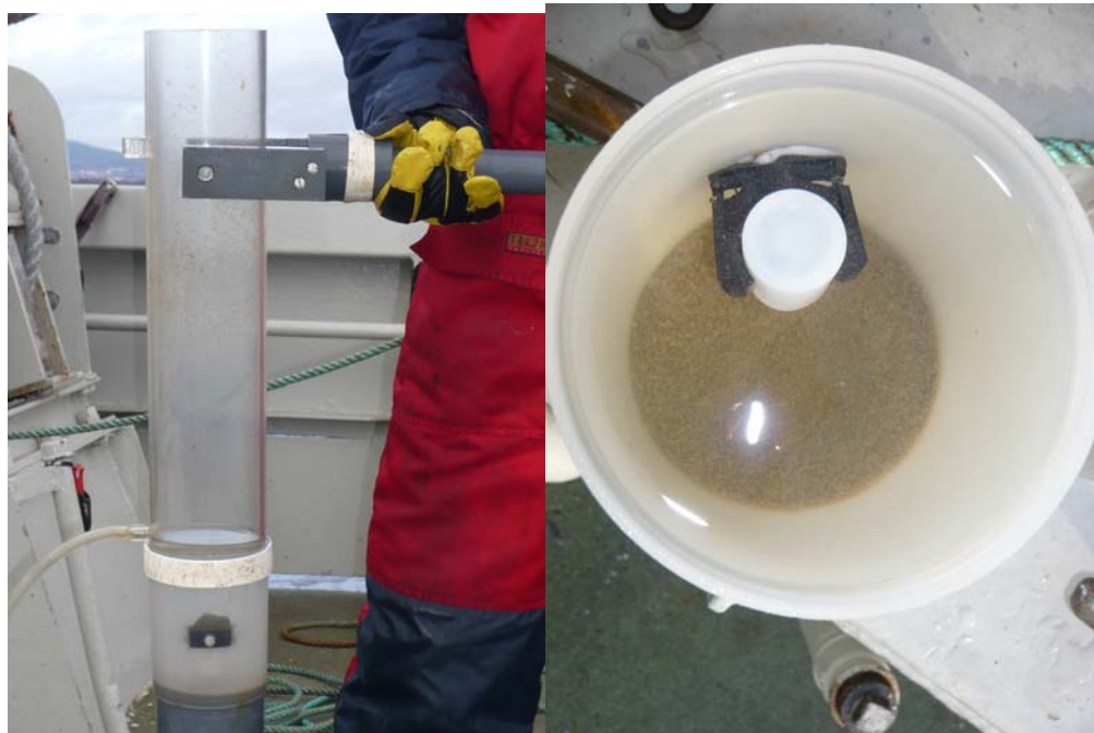
Figur 2 Fotografi av syllinder med prøvetakningskopp (til venstre). Til høyre er prøvetakningskopp vist ovenfra. Merk hvit beholder til konserveringsmiddel (formalin).
