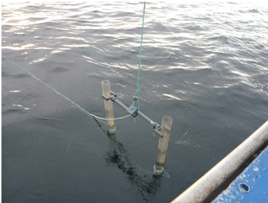
Figur 1 Sedimentfellerigg under innhenting 29/10-07
