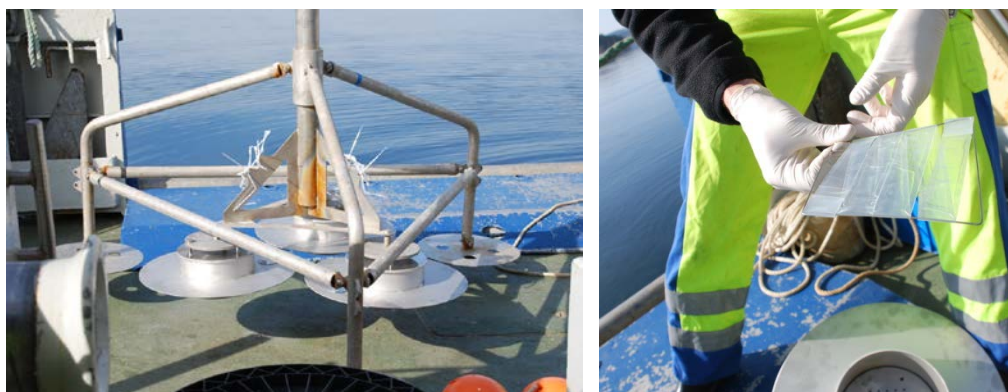
Figur 7 Bilder tatt under utplassering av tripod med diffusjonskamre den 26. mars 2012.
