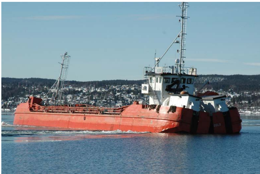
Figur 2. Secoras splittlekter Mudder 079 som ble benyttet til utlegging av overdekningsmaterialet på Malmøykalven.
