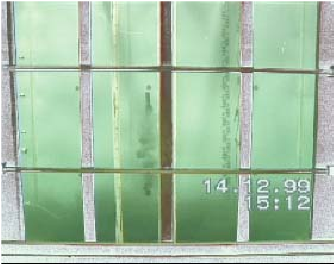
Figur 1. Støtvis utpumping av sediment fra Bjørvika til kar med anoksisk sjøvann fra Bekkelagsbassenget, temperatur 7°C, saltholdighet ca 30 PSU. Karet på bildet er 3 m høyt, 3 m bredt og 1 m dypt. Sedimentet ble skjøvet ut støtvis gjennom et rør gjennom bakveggen litt over midten av karet. Den nedsynkende klumpen med hale ses tydelig i midten av bildet. Sediment fra tidligere utskyvninger skjuler de nederste ca 60 cm av linjalen montert på karetets bakvegg. Turbiditeten i vannet over 60 cm var 1-2 NTU og økte til over 50 NTU i skyen ved bunnen.
