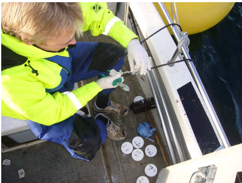
Figur 1 Passiv prøvetaker montert på signalkabel ved dypvannsdeponiet
