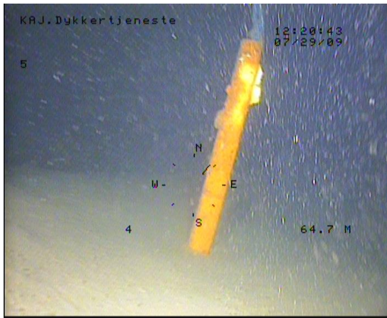
Skråstilt målepinne hvor dybdeindikator viser 64,7 m.
