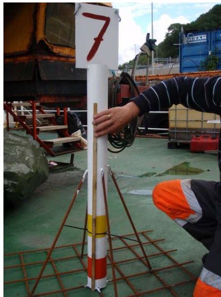
Figur 3. Andre generasjon målepinner som ble utplassert før andre runde med tildekning av dypvannsdeponiet på Malmøykalven.
