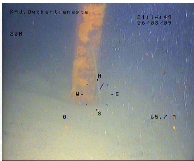
Noe skråstilt målepinne. Dybdeindikatoren viser 65,7 m.
