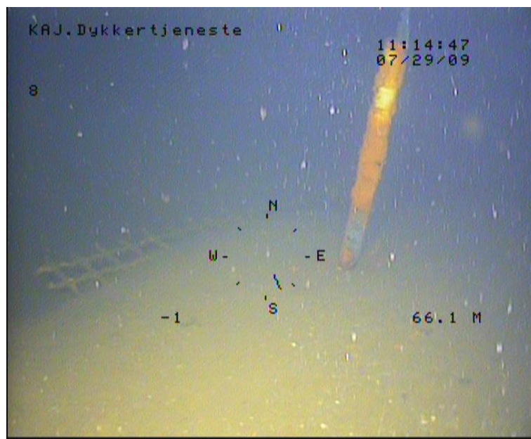
Skråstilt målepinne. Deler av armeringsmatte stikker opp over sedimentoverflaten.
