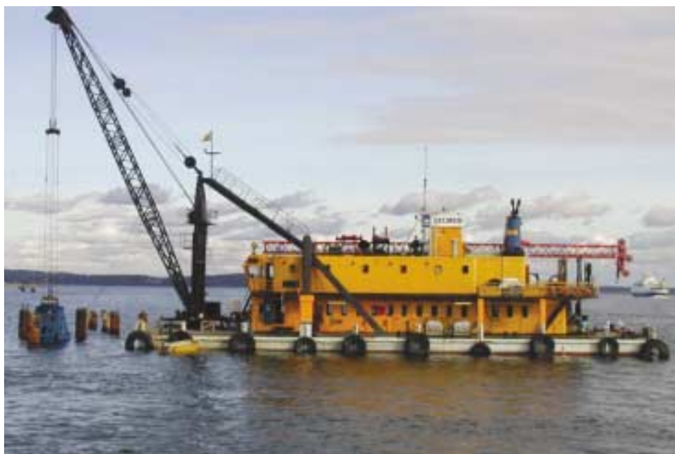
Fig. 2. Eksempel på grabbmudring. (Foto: SFT)
